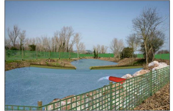
RENDERING_VASCA DI SEDIMENTAZIONE E INFILTRAZIONE
